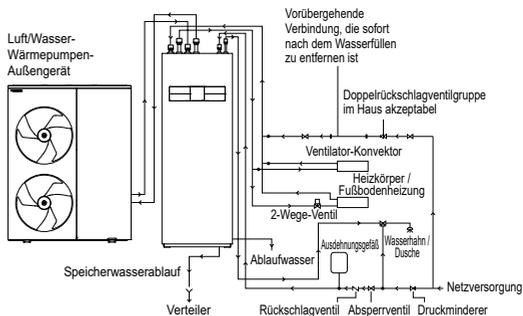
**Wenn das Innengerät (Splitgerät) angeschlossen ist**
