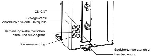
Ziehen Sie das Stromversorgungskabel und das Anschlusskabel **3** wie in der Abbildung gezeigt durch das Loch für das Anschlusskabel.
