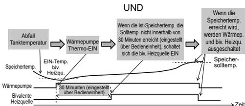
Bivalente Heizquelle Im Erweiterten Parallelbetrieb ist eine getrennte Einstellung für Pufferspeicher und Warmwasserspeicher möglich. Während des Heiz- und Warmwasserbetriebs („HEAT+TANK“) wird der Bivalenzausgang bei jeder Umschaltung der Betriebsart auf AUS zurückgesetzt. Für die Auswahl der optimalen Einstellung für das System ist ein gutes Verständnis der der Bivalenzfunktion erforderlich.
