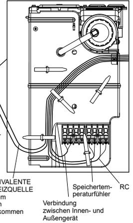
Führen Sie die Kabel wie in der Abbildung oben gezeigt.
